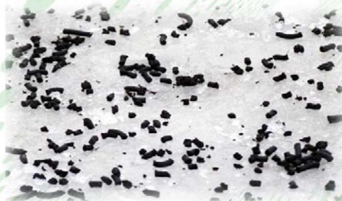
Основное преимущество средства “RastoPeat” заключается в том, что оно постепенно расплавляет лед с помощью реагентов, входящих в его состав, а также дополнительно воздействует на лед путем нагрева гранул за счет солнечной радиации. Пролонгированное действие “RastoPeat” определяется постепенным выходом химических реагентов, что повышает эффективность их использования.
