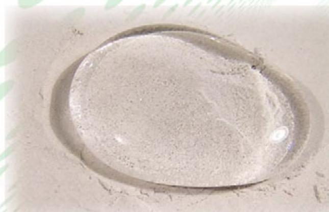
Добавка "Гигро-Стоп" может быть использована для снижения водопоглощения любых строительных конструкций, что позволит продлить их сроки эксплуатации. Данные независимой лаборатории по испытанию образцов бетона на прочность свидетельствуют о сохранении прочностных характеристик материалов, полученных на основе цементов, модифицированных с помощью добавки "Гигро-Стоп".
