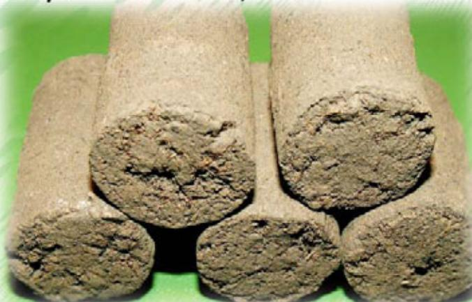
Полученные образцы обладают высокой плотностью (от 700 до 1200 кг/м<sup>3</sup>), прочностью (отсутствуют внутренние неоднородности в структуре, которые имеются при брикетировании на границе спрессованных частиц) и более низким водопоглощением (медленно поглощают воду, длительное время сохраняя свою структуру как гранулы).
