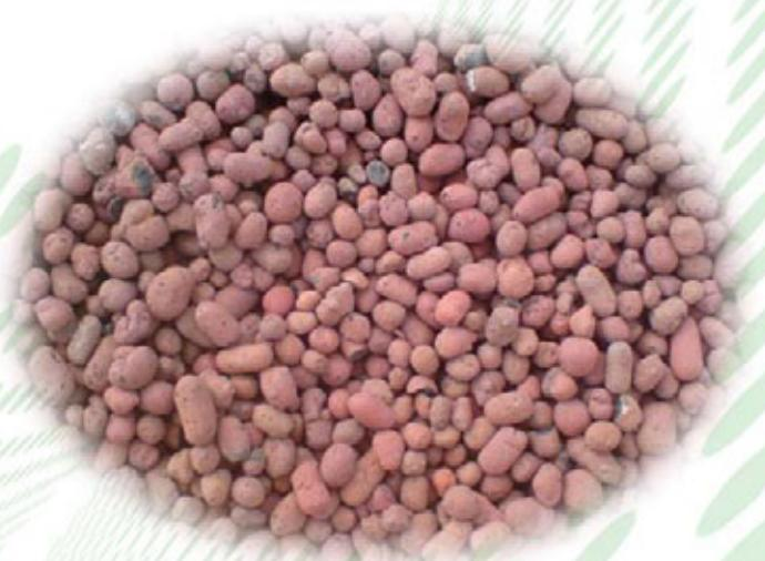
Пустоты, формирующиеся на внешней поверхности гранул доступны для цементного раствора, что прочно удерживает их в структуре бетона после твердения.
