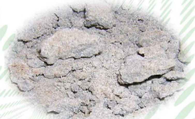
Бетон, полученный на основе гидрофобизированного с помощью добавки "Гигро-Стоп" цемента, обладает пониженными водопоглотительными свойствами, и может быть использован при строительстве гидротехнических сооружений и конструкций, находящихся в контакте с водной средой.
