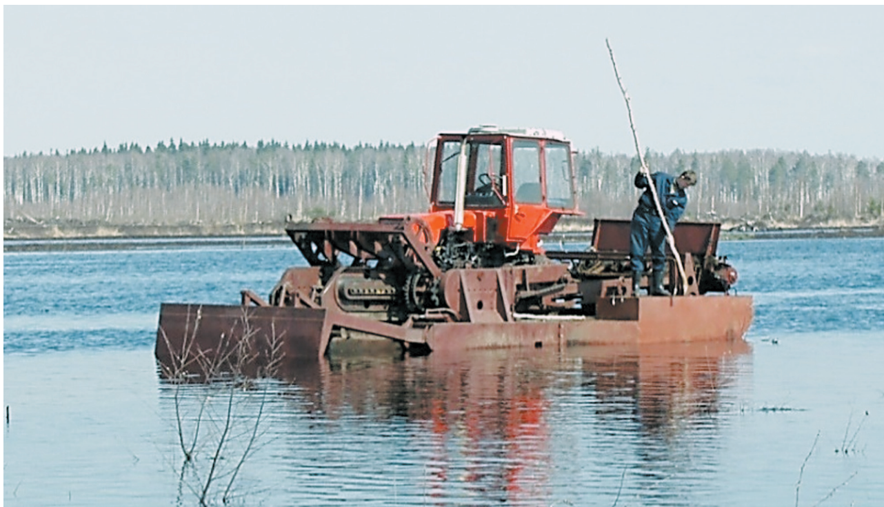
Рис. 4. Испытание шагающего болотохода БШМ-1 на плавучесть в Тверской области вблизи торфопредприятия «Емельяновское» на торфяном озере глубиной 2,5–3 м
