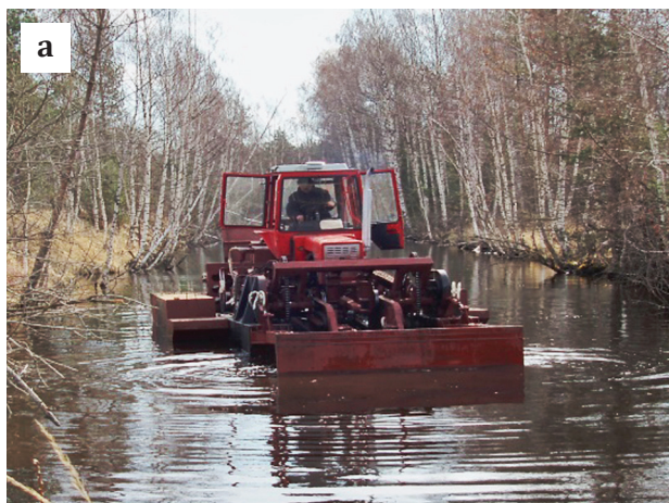
Рис. 5. Испытание шагающего болотохода БШМ на плавучесть в противопожарном канале: а – движение машины по воде за счет использования активных грунтозацепов; б – движение машины по воде за счет работы фрезы, используемой в качестве водяного движителя
