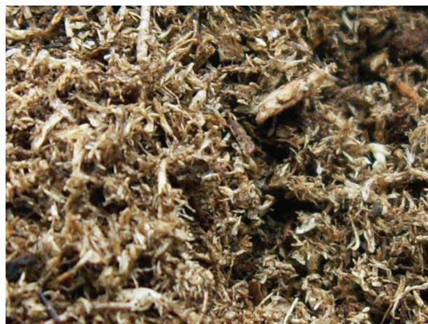
Рис. 2. Фото дисперсной комплексной стабилизирующей гидрофобно-модифицирующей добавки на основе торфа в ЩМА
