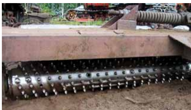
Рис. 1. Повреждения рабочего органа и режущих элементов фрезера МТФ-14 [6]
