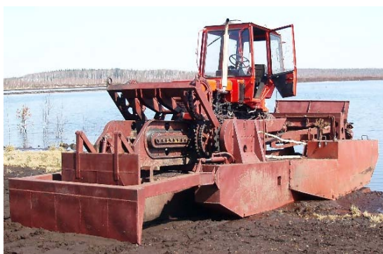
Рис. 5. Фото шагающего болотохода БШМ с двумя активными грунтозацепами с ручным управлением
