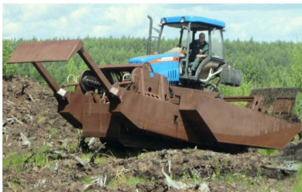
Рис. 6. Фото шагающего болотохода БШМ-1 с двумя активными грунтозацепами с ручным управлением
