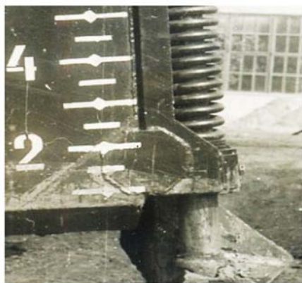
Рис. 2. Фото грунтозацепа правой боковой опоры шагающего болотохода БТ-1 конструкции КПИ
