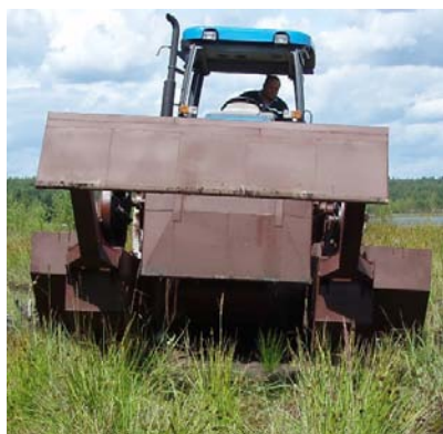
Рис. 6. Фото шагающего болотохода БШМ-1 с двумя активными грунтозацепами с ручным управлением
