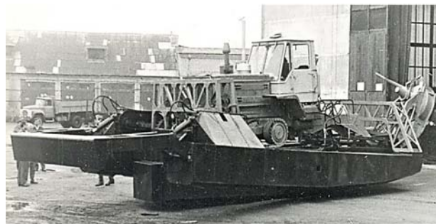
Рис. 4. Фото шагающего каналокопателя конструкции ТПИ с активным внешним грунтозацепом с ручным управлением
