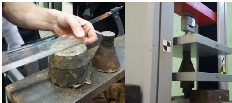
Рис. 5. Результаты испытаний на сжатие гранул Fig. 5. The results of compression tests of granules
