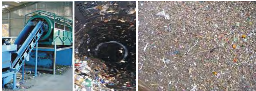
Рис. 1. Выбор фракций: >350 мм (больших) и <65 мм (малых) Fig. 1. Choice of fractions: >350 mm (large) and <65 mm (small)
