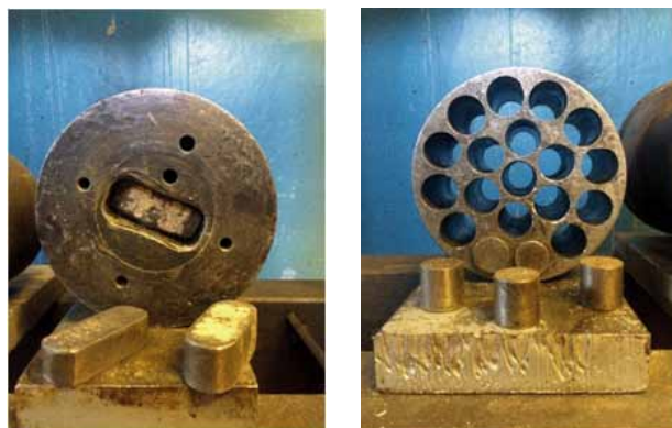
Рис. 3. Матрицы для формования брикета типа «салон» (а) и цилиндрической гранулы (б)
