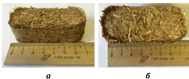
Рис. 4. Образец брикета из тростника типа «салон» (размер гранул 3–5 мм и более)
